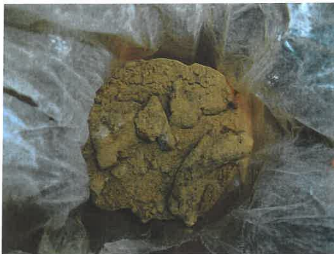
Couche de forme sous dallage : sables fins avec poches d'argile marron
